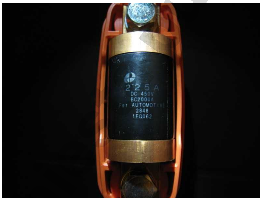
Figura 3-12 – Fusibile presente all'interno della batteria di alta tensione di veicoli ibridi e/o elettrici
