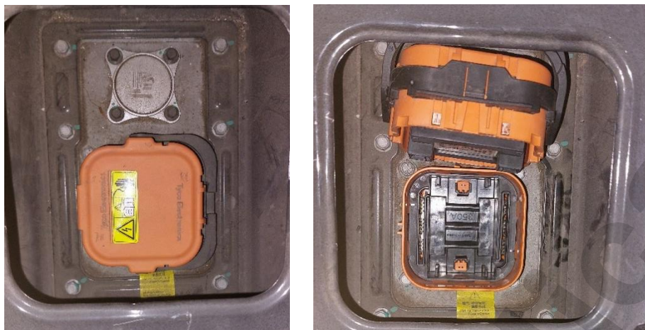
Figura 3-11 – Esempio di sezionamento fisico compiuto tramite un service-plug presente sul corpo della batteria di trazione
